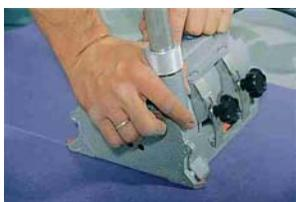
Герметизация швов сварочным шнуром осуществляется с помощью аппарата для ручной сварки со специальной насадкой 5 мм. Температура сварки составляет 400-450 С<sup>0</sup>, скорость примерно 4-5 метров в минуту.
